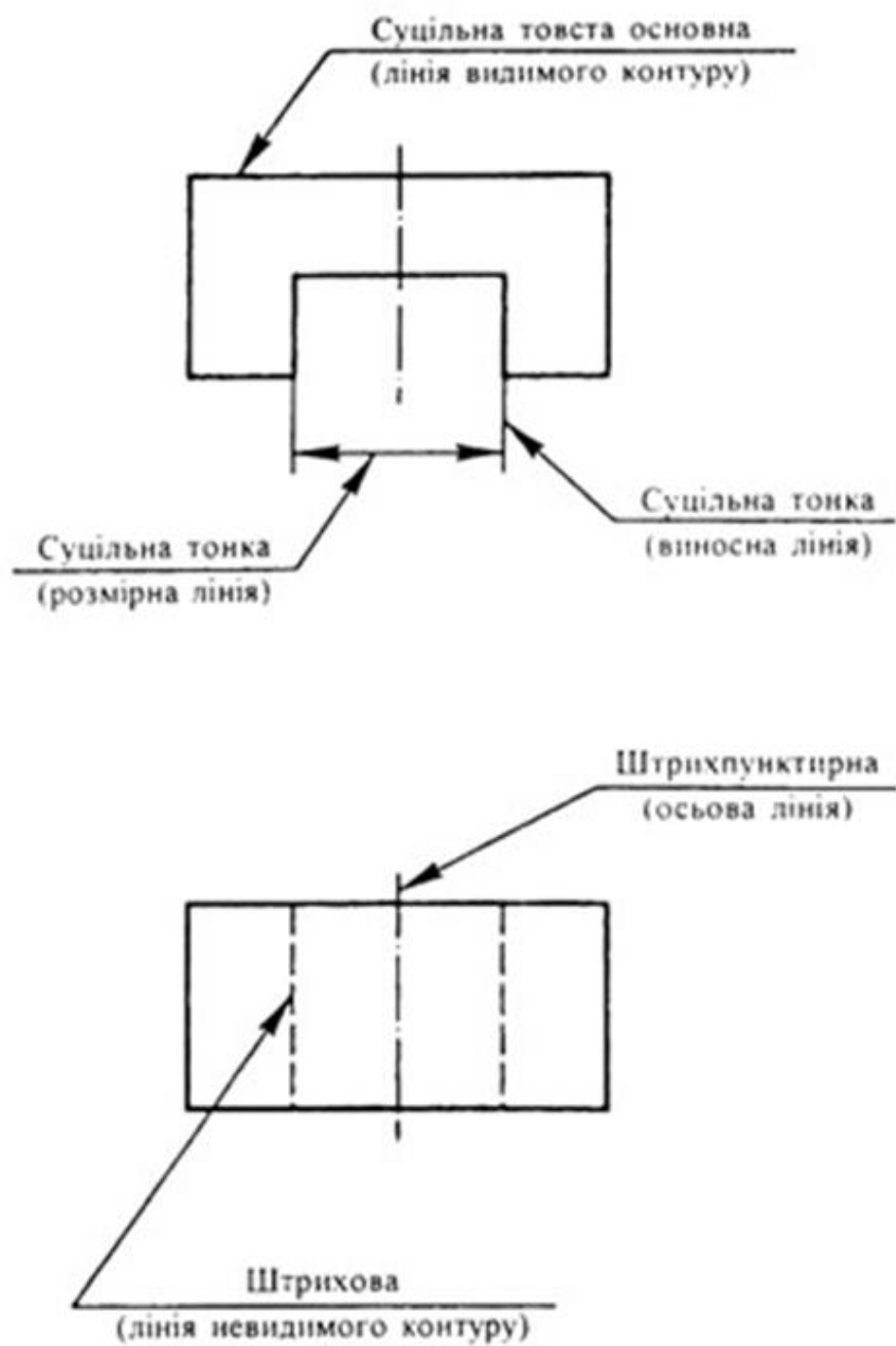
Рис. 1. Призначення основних типів ліній креслення
